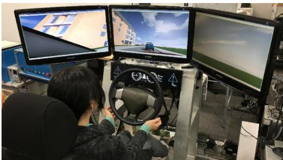
図1. HMIを備えた簡易型VRシミュレータ
